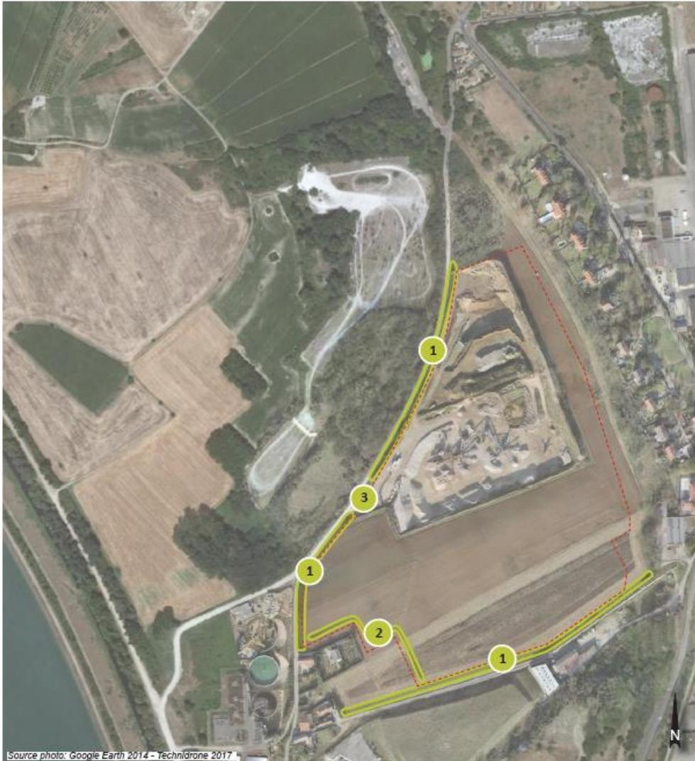
Les mesures de réduction d'impacts proposées en cours d'exploitation se feront essentiellement par le traitement paysager des lisières de l'emprise de la carrière, réalisé sur la bande des 10 mètres selon le schéma ci-dessous.
